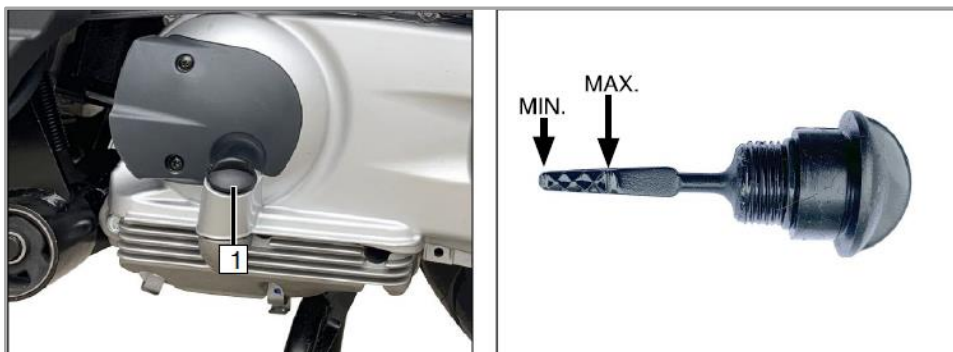
1. Tampão do reservatório
