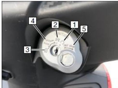
1. **ON** ☉ - Ao rodar a chave para esta posição, todos os circuitos elétricos são ativados, o motor pode ser ligado e a chave não pode ser removida.
