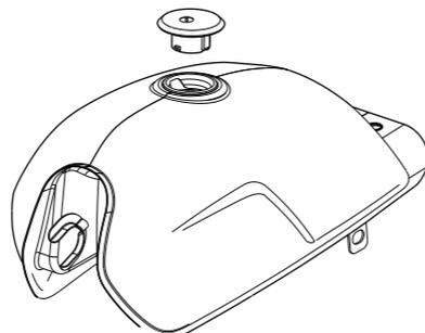
Para abrir o tampão do depósito, insira a chave no canhão do tampão e rode-a no sentido dos ponteiros do relógio. Para fechar o tampão proceda de forma inversa. Assim que estiver fechado, remova a chave.
