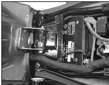
Este modelo está equipado com uma bateria VRLA (chumbo-Ácido regulada por válvula), ou seja, bateia selada e livre de manutenção.
