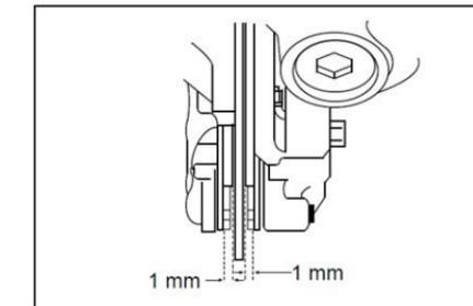
Os indicadores de desgaste das pastilhas de travão permitem verificar o desgaste sem desmontar o travão. Se o indicador quase tocar no disco do travão, entre em contacto com o seu concessionário para fazer a troca das pastilhas.
