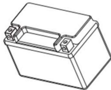
Este modelo está equipado com uma bateria selada, e livre de manutenção. Não existe a necessidade de verificação do eletrólito ou adicionar água destilada. Contudo, é necessário verificar se os cabos estão bem apertados nos bornes e, caso não estejam, apertá-los
