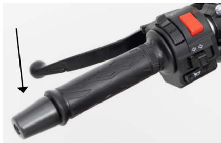
A manete de embraiagem encontra-se do lado esquerdo do guidador. Ao pressioná-la na direção do guidador é interrompida a ligação entre o motor e as rodas.
