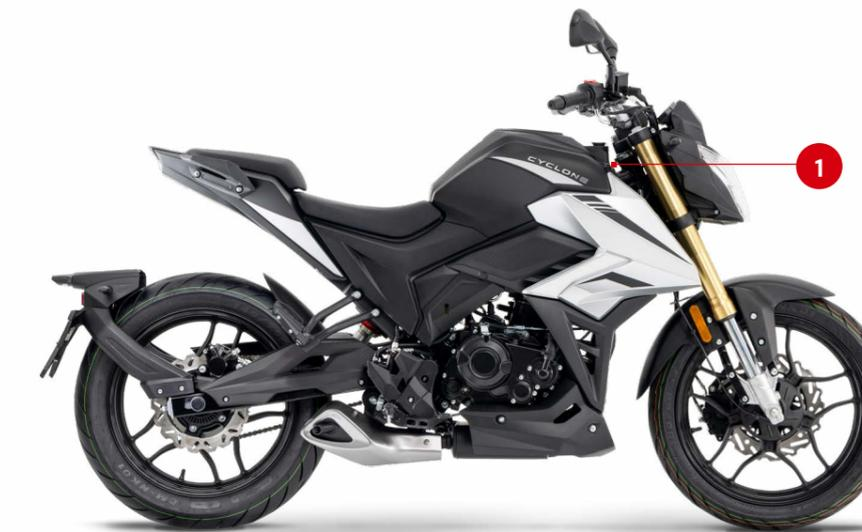
O Número de Identificação do Veículo (VIN) (1) encontra-se marcado no quadro, junto à coluna de direção.
